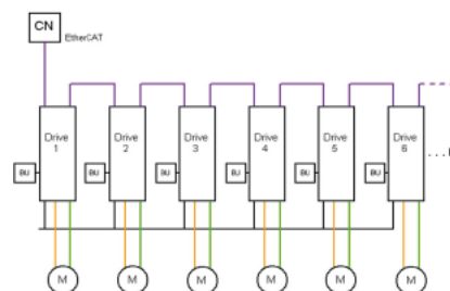
Soluzione tradizionale: un servozionamento per ciascun asse
