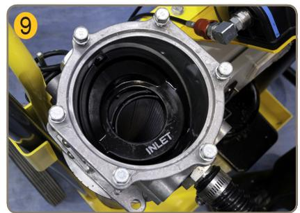
In caso di fluidi molto viscosi, può essere necessario versare 1-2 litri d'olio nel filtro di ingresso per adescare la pompa.
