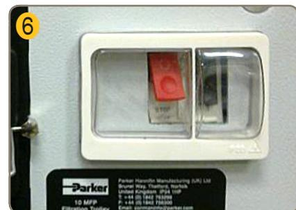
6 Portare l'interruttore di sovraccarico in posizione ON.
