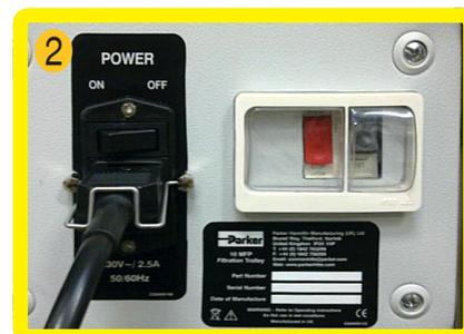
Collegare la presa elettrica al carrello e abbassare il fermo anti-scollegamento. Collegare la spina alla presa di rete.
