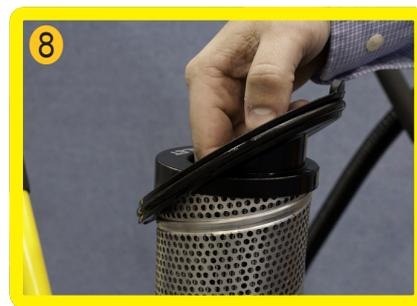
Installare i nuovi elementi e rimontare l'O-ring del filtro.
