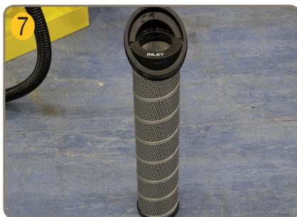
Sostituire il setto filtrante. Gli elementi in rete metallica possono essere puliti ad ultrasuoni (contattare Parker per informazioni).
