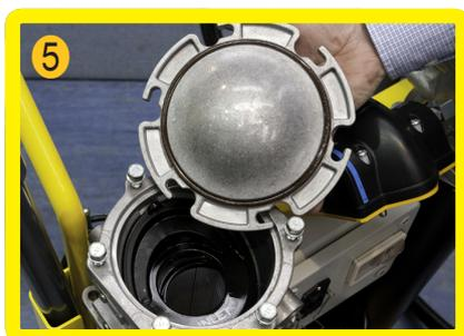
... e sollevarlo. Verificare l'O-ring nel coperchio e sostituirlo qualora sia usurato o danneggiato.
