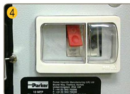
Portare l'interruttore di sovraccarico in posizione ON.
