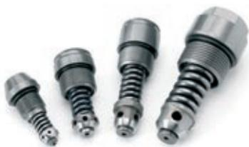
Valvole di scarico della pressione a controllo diretto con funzione anticavitazione. Queste valvole hanno buone caratteristiche di pressione e tempi di reazione estremamente ridotti. Sono compatte, affidabili, stagne ed a prova di impurità.
