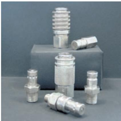
Gli innesti diagnostici forniscono punti di prova facilmente accessibili per la verifica delle prestazioni degli impianti idraulici di stabilimenti o veicoli. La ricerca dei guasti tempestiva assicura la massima efficienza e durata delle attrezzature. Le serie Parker PD e PDP combinano diversi vantaggi: conformità ISO 15171-1 e SAE J1502 per la massima intercambiabilità, innesti piani per le minime perdite, possibilità di collegamento sotto pressione ecc.
