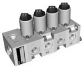
Il gruppo di valvole modulari serie PVC6 viene utilizzato per il comando remoto delle valvole di comando direzionali. La valvola di riduzione della pressione proporzionale crea una pressione proporzionale alla corrente in entrata. La bobina del solenoide può essere alimentata a 12 o 24 Volt. La sezione di entrata può essere dotata di una valvola di riduzione della pressione per proteggere le sezioni di comando (la pressione max in entrata alla sezione di comando è 50 bar).
