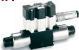
La commutazione lineare della valvola D1VW Soft Shift è garantita dall'ammortizzazione dello stantuffo nel tubo per mezzo di un orifizio.
