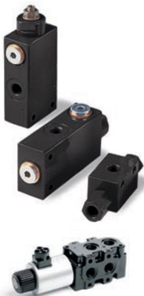
La valvola impilabile Parker viene attivata direttamente dai solenoidi nell'indotto a bagno d'olio. Questa valvola è in grado di commutare da un circuito all'altro a diverse portate e pressioni. Se devono essere controllati più di due circuiti, è possibile unire due unità aggiuntive. In alternativa, è possibile collegare la valvola a un circuito e dirigere il flusso a uno o due circuiti diversi.
