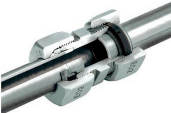
La versione EO-2 della serie di raccordi EO è un sistema di raccordo con tenute morbide su tutti i giunti. La caratteristica più importante è l'uso del dado funzionale EO-2 in sostituzione dell'anello progressivo.
