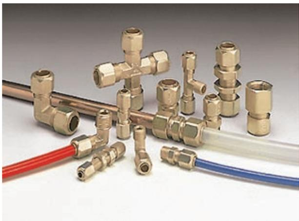
Metrolok è un raccordo monoblocco pronto all'uso per tubi di rame o plastica. L'anello di taglio è fissato all'interno del dado. I raccordi Metrolok sono riutilizzabili.
