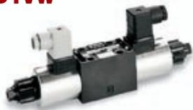
D1VW è una valvola di comando direzionale a 4/3 o 4/2 vie e 3 camere, a controllo elettrico. Essa viene attivata direttamente dai solenoidi nell'indotto a bagno d'olio.
