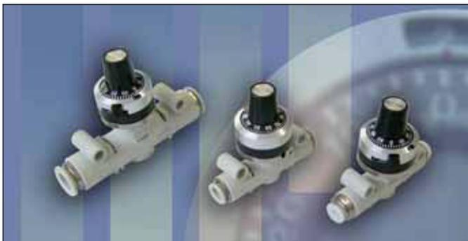
Regolatori di flusso di alta precisione, l'indicatore multi-giro integrato consente una regolazione fine e continua del flusso erogato ed estrema semplicità nel riportare il flusso su valori impostati in precedenza. Fissaggi orientabili, totale adattabilità alla geometria di installazione e ridotti i tempi di fissaggio.
