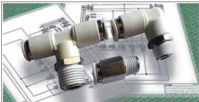
Raccordi rapidi di alta qualità, per pressione e vuoto (-100KPa ~1MPa), le parti in metallo interamente cromate rendono il raccordo inattaccabile da agenti ossidanti ed acidi garantendo l'affidabilità nel tempo di tutto l'impianto, temperature d'impiego da -10°C a +60°C. Figure curve, T, Y e distributori multipli completamente orientabili.
