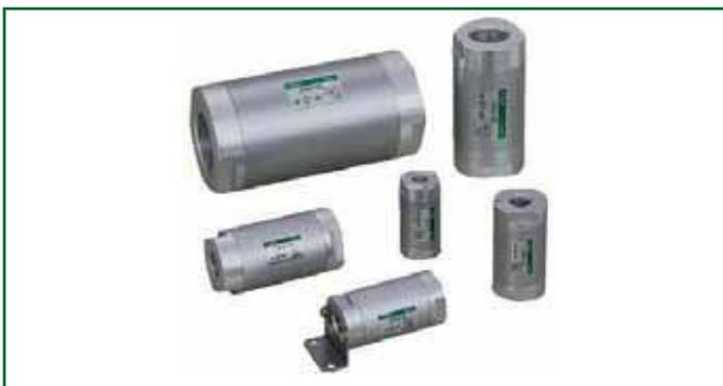
Valvole unidirezionali, ideali per applicazioni pneumatiche ed idrauliche a bassa pressione, l'accurata realizzazione delle sedi consente l'impiego di molle di richiamo molto leggere, questo si traduce in una elevata sensibilità di apertura.
