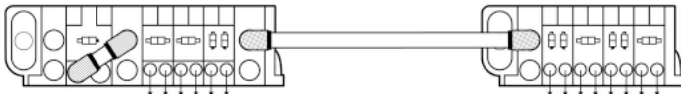
Valvola di scarico 4/2 monostabile taglia 2
